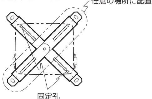
4. 水平な場所に組み立てた架台を置き、アンカーボルトを打ち込む場所をマークします。アンカーボルトを打ち込んだら架台と固定してください。
