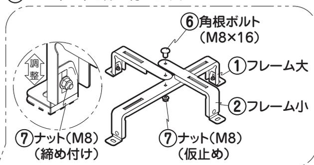
3. ポンプ本体の固定孔にあわせて②フレーム小を移動させます。その後、仮止めしていた中央の⑦ナット(M8)を締め付けてください。
